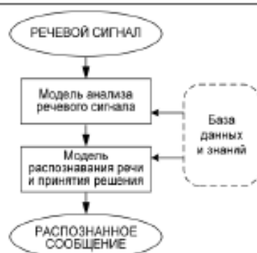
Рисунок 1. Структурная схема СААР (системы автоматического распознавания речи)
